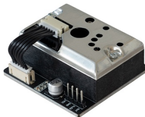
capteur SEN GP2Y1014AU
